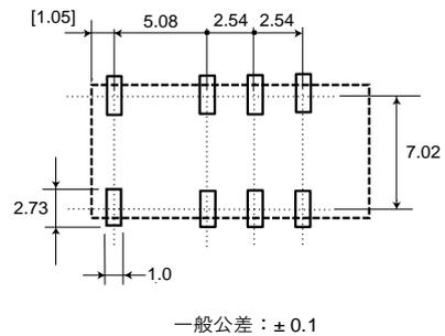
端子接线图 (Top view)
