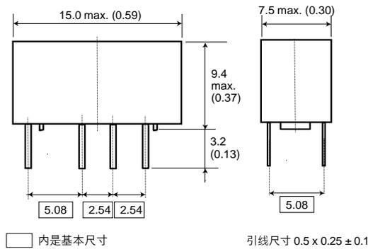
微引脚型: 引线长度 2.8mm
