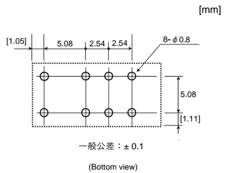
端子接线图 (Bottom view)
